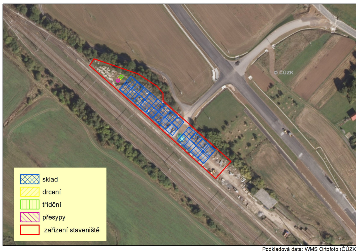
Obr. 3: Schematický zakres rozdělení a umístění plošných zdrojů znečištění
