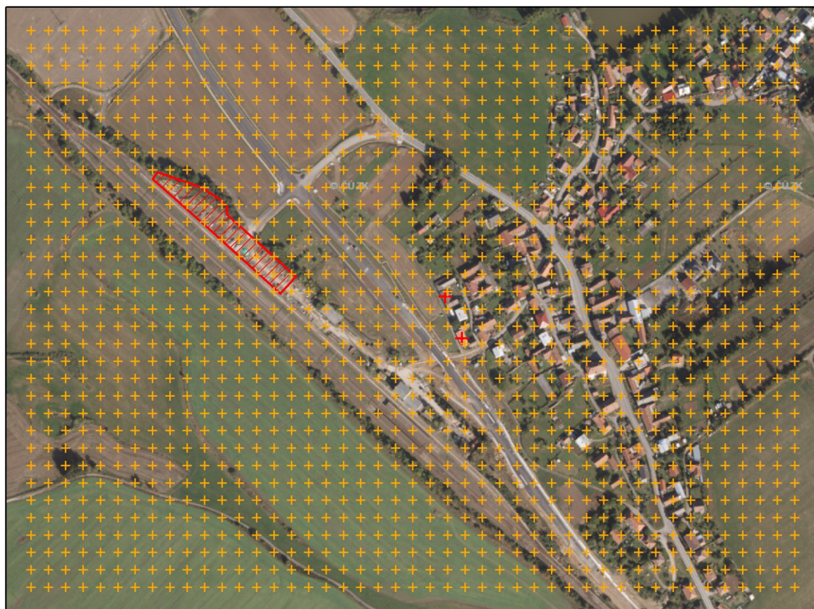
Obr. 7: Rozložení referenčních bodů v okolí stavebního záměru použitých pro modelování v programu Symos '97
